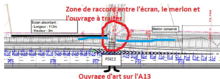
Figure 7 : Implantation par rapport à l'ouvrage d'art (PS 92,2), du nouvel écran (trait noir), du merlon existant (trait bleu). Le merlon à gauche sera remplacé par l'écran) Source : dossier et Ae.
